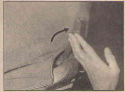
28.11 ...откройте верх приблизительно на 18 см и толкните защелку назад в запирающее положение. Если защелку не запереть, можно повредить сдвигающийся верх
